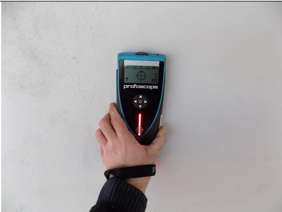
Fot. 8 Pomiar otuliny na przeponie.
