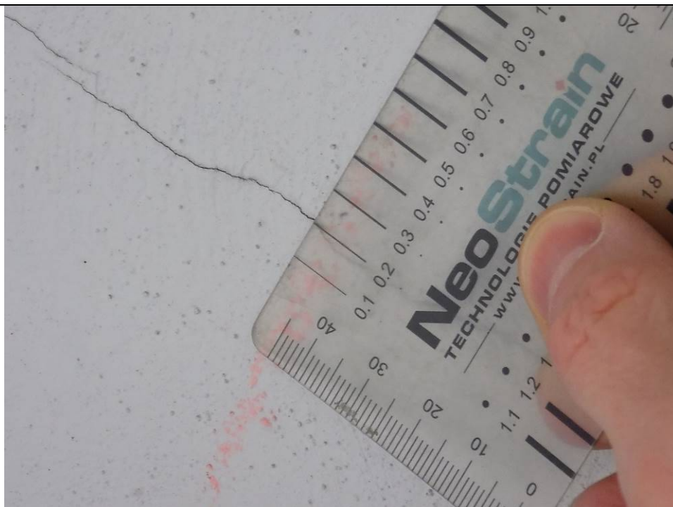
Fot. 10 Pomiar rysy ukośnej na przeponie 0,2 mm.
