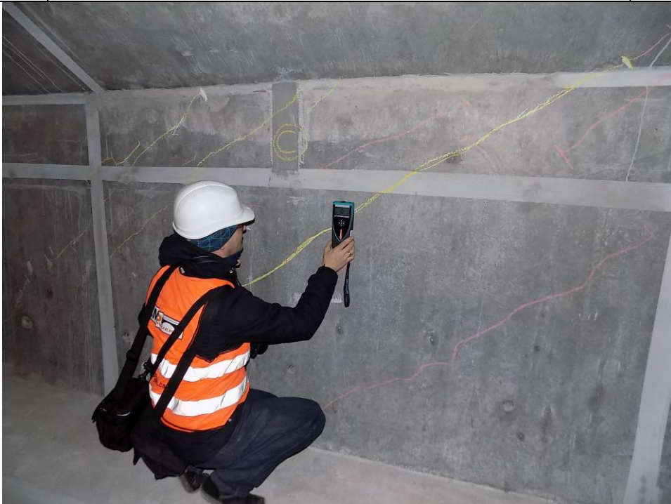
Fot. 11 Widok na pomiar grubości otulenia na przeponie od strony wewnętrznej. Widoczne zarysowania ukośne przepony.
