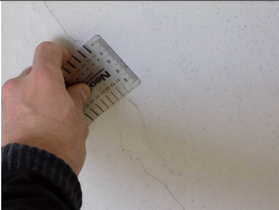
Fot. 2 Pomiar rozwartości rys na przeponie od strony zewnętrznej (0,2 mm).
