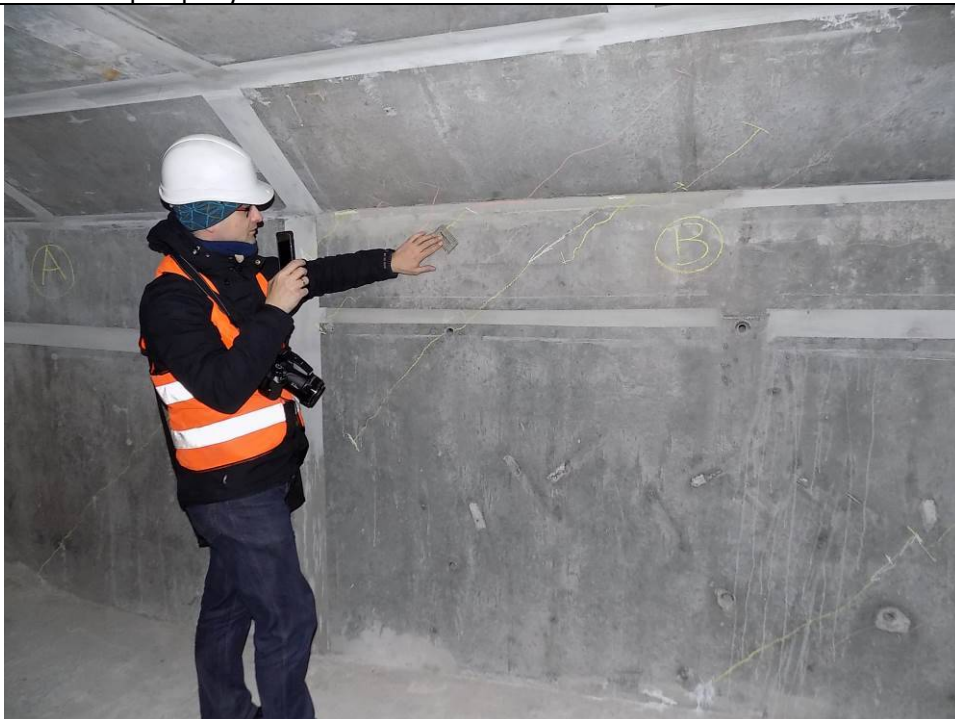
Fot. 12 Pomiar zarysowania na przeponie od strony wewnętrznej.
