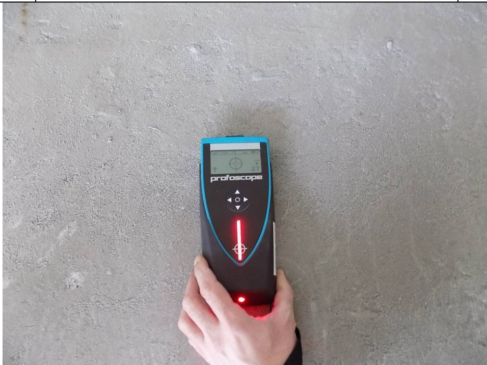
Fot. 9 Pomiar otuliny na stopce przepony.
